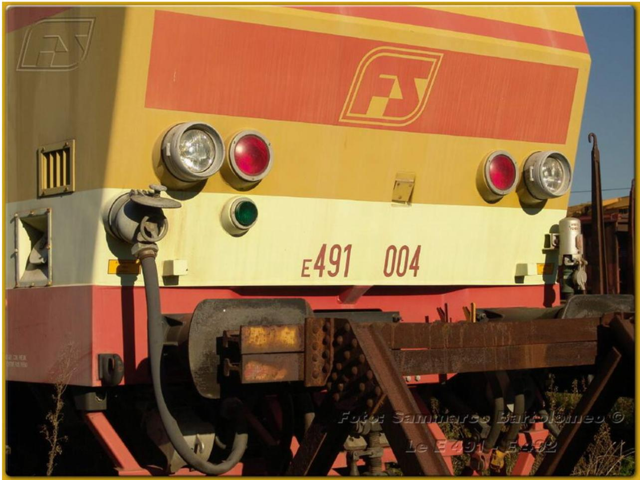
Le loco sono munite di accoppiatore a 78 poli e predisposte per la condotta a 13. E' possibile accoppiare due loco anche di gruppo diverso. Per una terza eventuale macchina si abilita la sola comunicazione citofonica.
